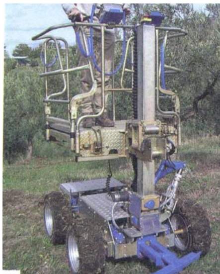
Figura 3. a) Piattaforma aerea semovente, che velocizza le operazioni di potatura evitando l'impiego di scale con aumento di sicurezza delle lavorazioni; b) piattaforma semovente con possibilità di telecomando, adatta alle operazioni di potatura anche in terreni in pendenza. Da: L'Informatore Agrario n. 38/2006.
