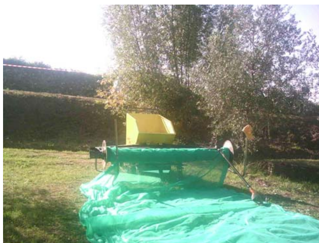
Figura 12. Sistema meccanico che consente di stendere le reti lungo il filare e consente il loro veloce riavvolgimento una volta svuotate dalle olive. Foto scattata a Montepaldi, San Casciano val di Pesa, durante la giornata dimostrativa del progetto MATEO il 26 novembre 2006.
