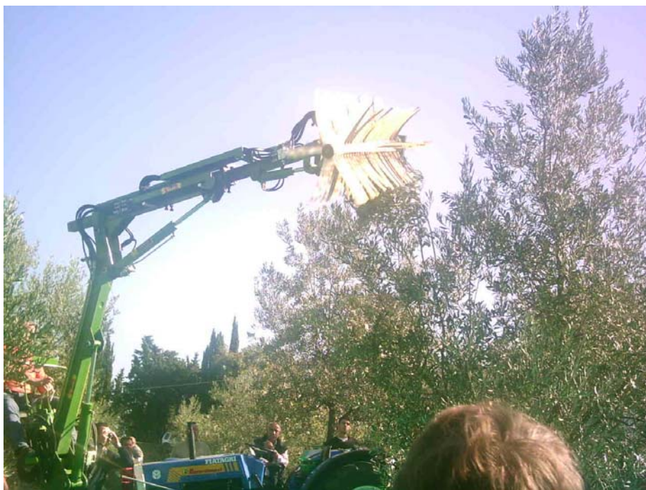
Figura 9. Macchina con testata pettinatrice dotata di denti in vetroresina di circa 1 m di lunghezza. La testata pettina i diversi settori della chioma. Foto scattata a Montepaldi, San Casciano val di Pesa (FI), durante la giornata dimostrativa del progetto MATEO il 26 novembre 2006.
