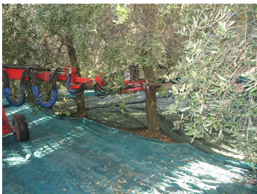
Figura 35. Macchina vibro-scuotitrice della ditta Berardinucci che opera in un oliveto con sesto d'impianto di 6 x 3 m su piante allevate a monocaule, non potate nel 2006. Castagneto Carducci (LI).
