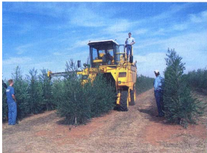
Figura 10. Macchina scavallatrice per la raccolta in continuo. Macchina utilizzata su oliveti specializzati caratterizzati da elevata densità d’impianto, elevata produttività, ridotte dimensioni delle piante. Macchina che rende possibile la meccanizzazione integrale della raccolta. Da: L’Informatore Agrario n.38/2006
