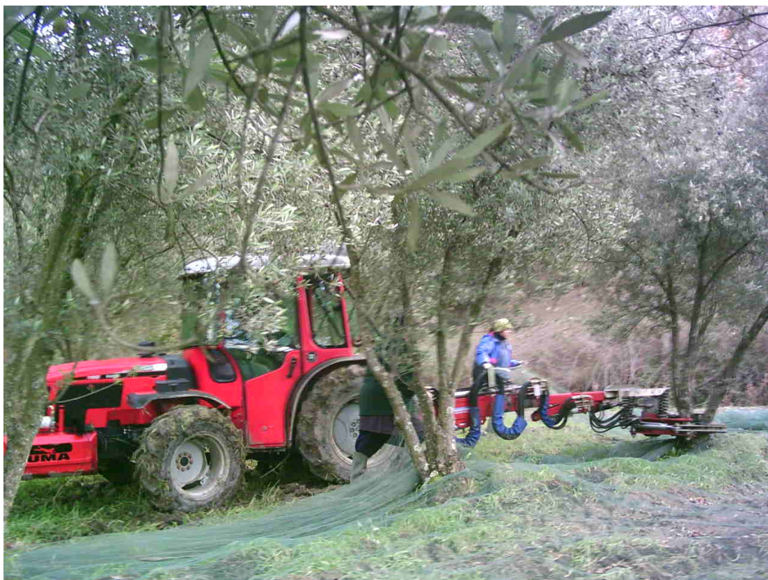
Figura 8. Scuotitore del tronco dotato di braccio oscillante e telescopico con testata a pinza sulla quale sono montate masse eccentriche con movimento multidirezionale. Foto scattata a Pontassieve (FI), presso l'azienda "Fattoria di Grignano".
