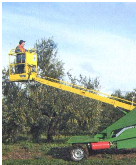
Figura 3. a) Piattaforma aerea semovente, che velocizza le operazioni di potatura evitando l'impiego di scale con aumento di sicurezza delle lavorazioni; b) piattaforma semovente con possibilità di telecomando, adatta alle operazioni di potatura anche in terreni in pendenza. Da: L'Informatore Agrario n. 38/2006.
