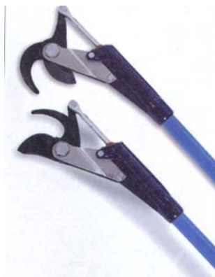
Figura 4. Cesoie montate su aste azionate pneumaticamente che agevolano notevolmente le operazioni di potatura. Da: L'Informatore Agrario n.38/2006.
