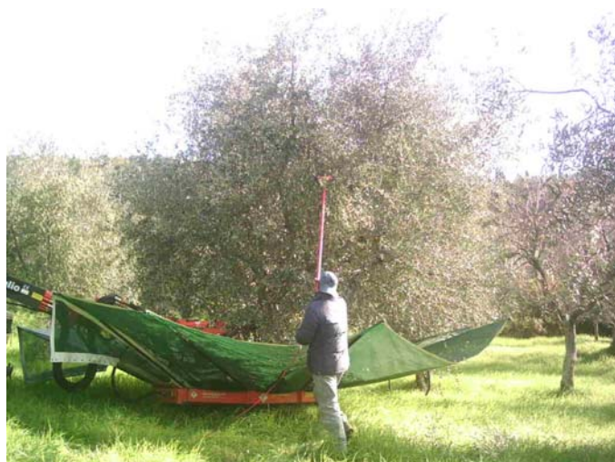
Figura 11. Scuotitore del tronco con telaio per l'intercettazione ed il recupero delle olive. Modello VMA88, ditta Verdegiglio (BA). Fiesole (FI), 2005.
