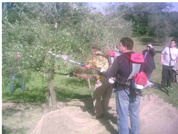
Figura 6. Scuotitore manuale azionato da un motore a scoppio portato dall'operatore. Foto scattata a Montepaldi, San Casciano Val di Pesa, durante la giornata dimostrativa del progetto MATEO il 26 novembre 2006.
