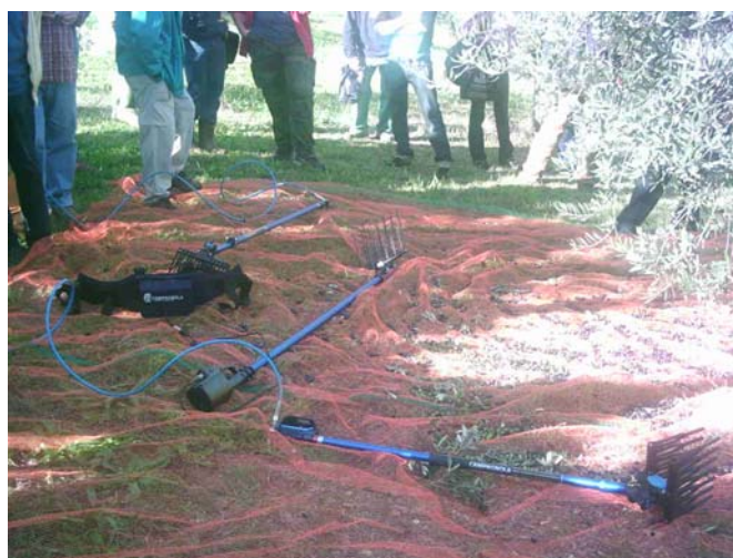
Figura 7. Pettini pneumatici ed elettrici della ditta Campagnola. L'organo di lavoro è a doppio pettine, è caratterizzato da un'azione rastrellante e vibrante; nella foto è visibile la batteria ed il tubo di raccordo. Foto scattata a Montepaldi, San Casciano val di Pesa, durante la giornata dimostrativa del progetto MATEO il 26 novembre 2006.
