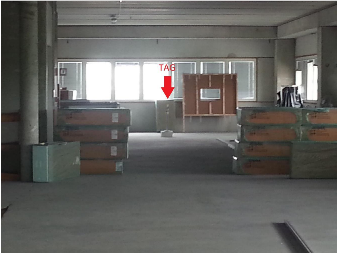
Figura 72) Tag posto nel punto (x=33.13m, y=4.294m, z=0.949m) del sistema di riferimento, con mascheramento parziale della line of sight
