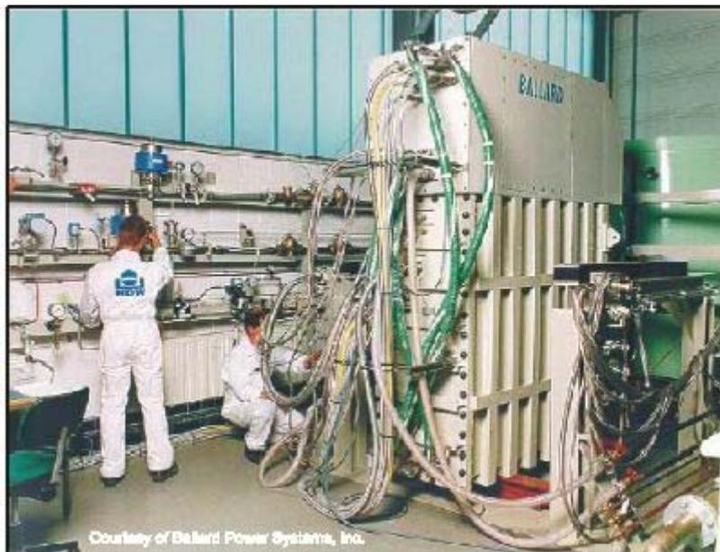
Figura 2.42 – Impianto a celle a combustibile da 80 kW alimentate con idrogeno e ossigeno, costruito dalla *Ballard Power Systems* per il costruttore tedesco di sottomarini *Howaldtswerke-Deutsche Werft AD*
