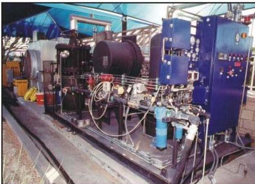
Figura 2.48 – Reformer di medie dimensioni alimentato da gas naturale
