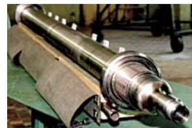
Figura 1.22 - Cuscinetto elettromagnetico, turbina a gas e recuperatore del reattore GT-MHR
