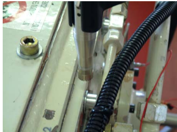
Figura 7- 25 Microfono \perp al fronte d'onda a 10 mm dal coperchio spostato internamente di 20 mm
