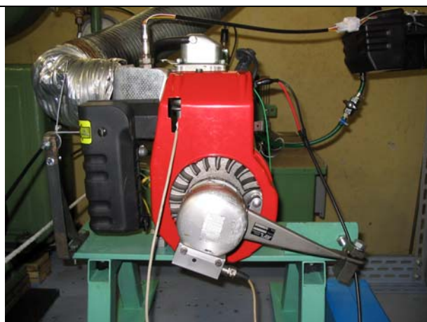
Figura 6.8 – Il sensore ottico posizionato sul volano. A destra è possibile vedere l'elemento di vincolo fra statore e telaio motore.
