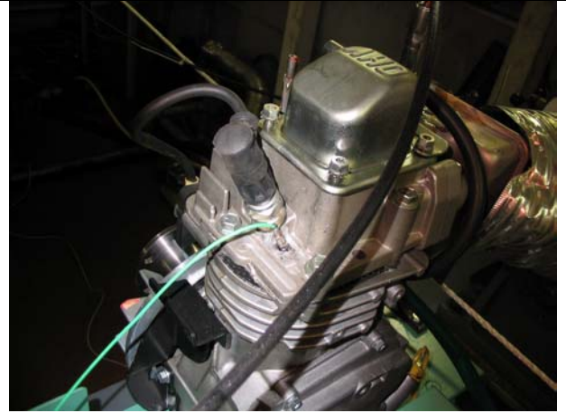
Figura 6.6 – Vista del posizionamento del trasduttore di pressione. Il sensore è collocato nei pressi della candela: si può vedere il cavo del sensore, di colore verde.
