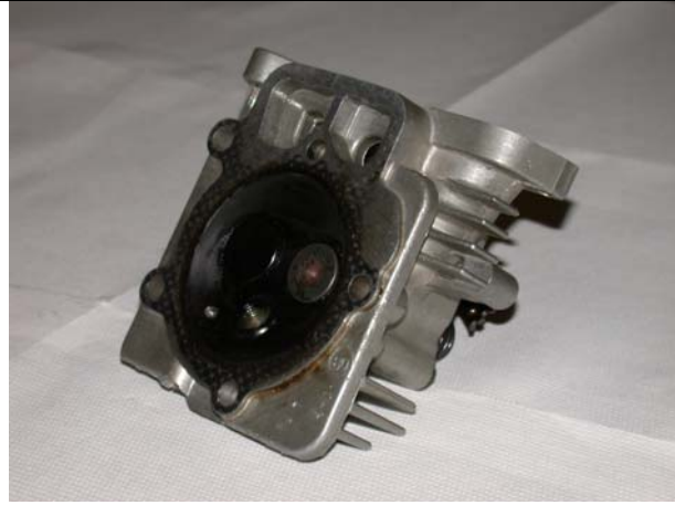
Figura 6.5 – Vista della testata del motore
