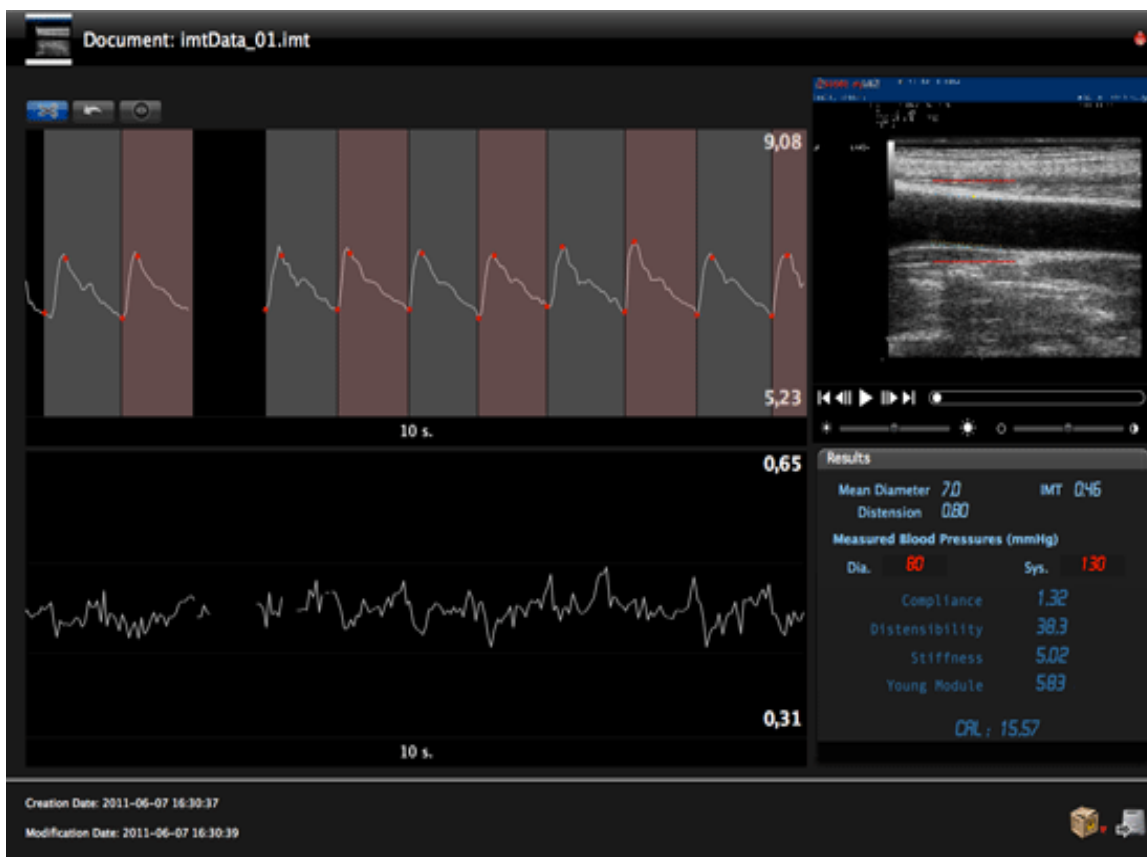
FIGURA 3: Interfaccia grafica del sistema automatico utilizzato per la valutazione istantanea del diametro (in alto a sinistra) e dello spessore medio-intimale carotideo (in basso a sinistra).
