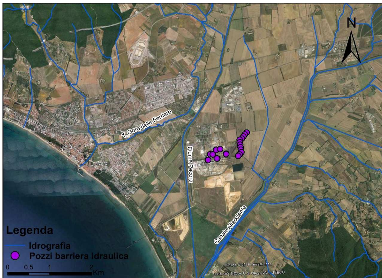
Figura 14: Attuale barriera idraulica presente nella zona del Casone.
