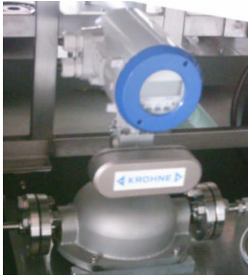
**Figura 3.25 Flussimetro Optimass 7100**
