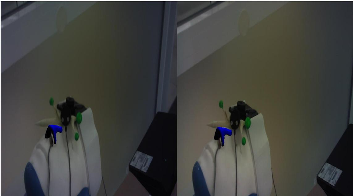
*Figura 14 Le immagini sinistra e destra mandate al visore AR per fornire una visione stereoscopica della scena, in blu la struttura virtuale generata dalla segmentazione in fase di pianificazione, il sensore associato ad esso è posto all'interno del naso del fantoccio*
