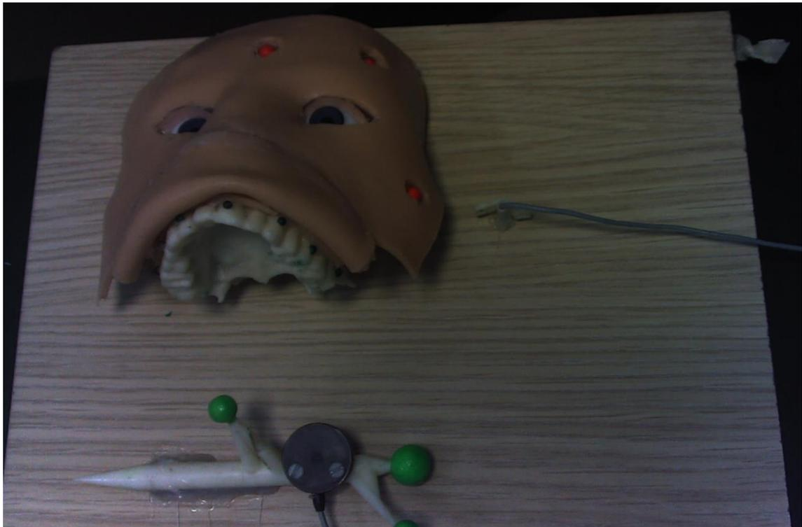
*Figura 18 Setup sperimentale per la simulazione dell'intervento di osteotomia Le Fort I mini-invasivo*
