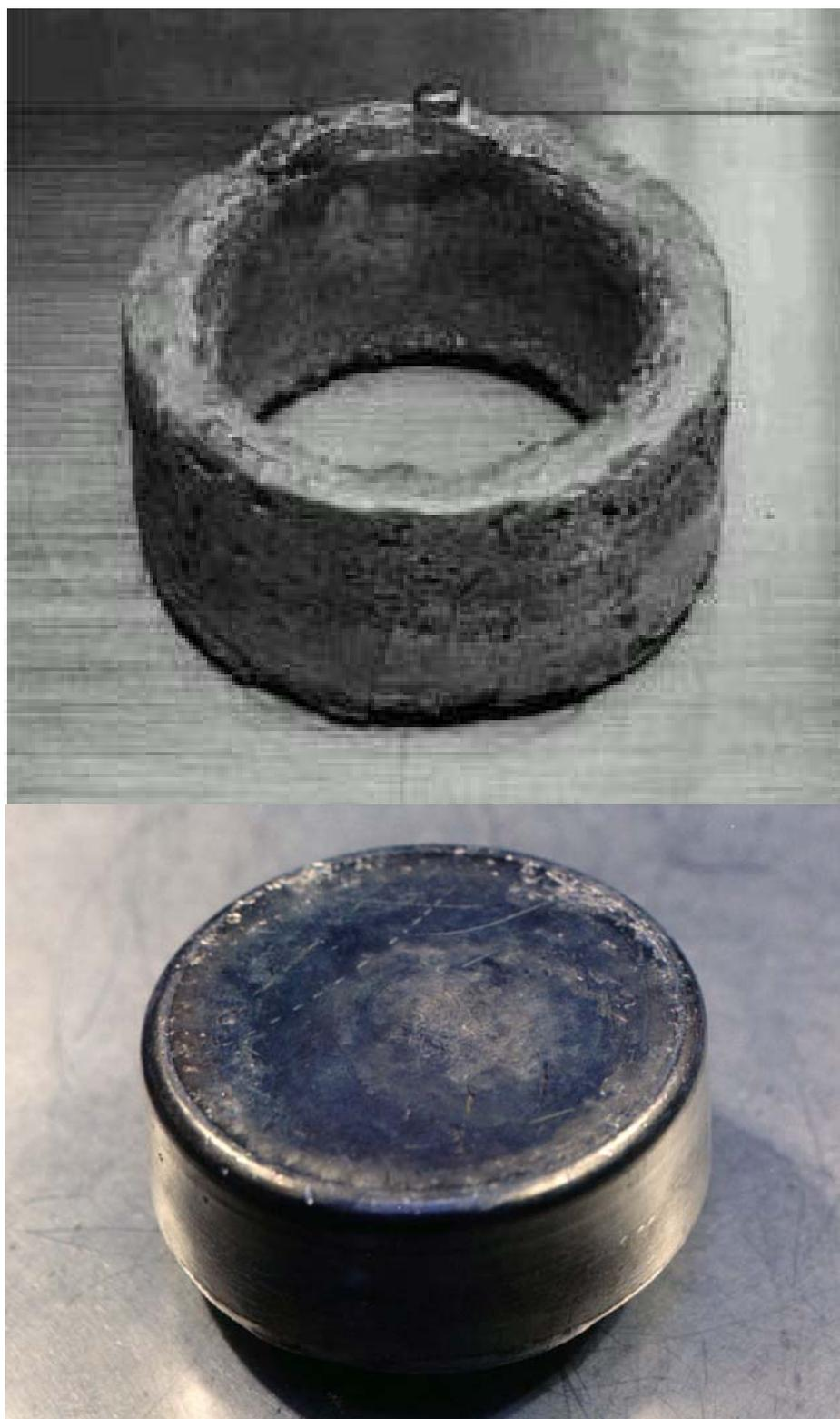
Figura 5.18 - Plutonio grezzo (in alto) e lingotto lavorato additivato con gallio (in basso) [5.3]
