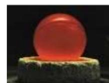
Figura 5.10 -  $\text{Pu}^{238}$  usato come sorgente di energia
