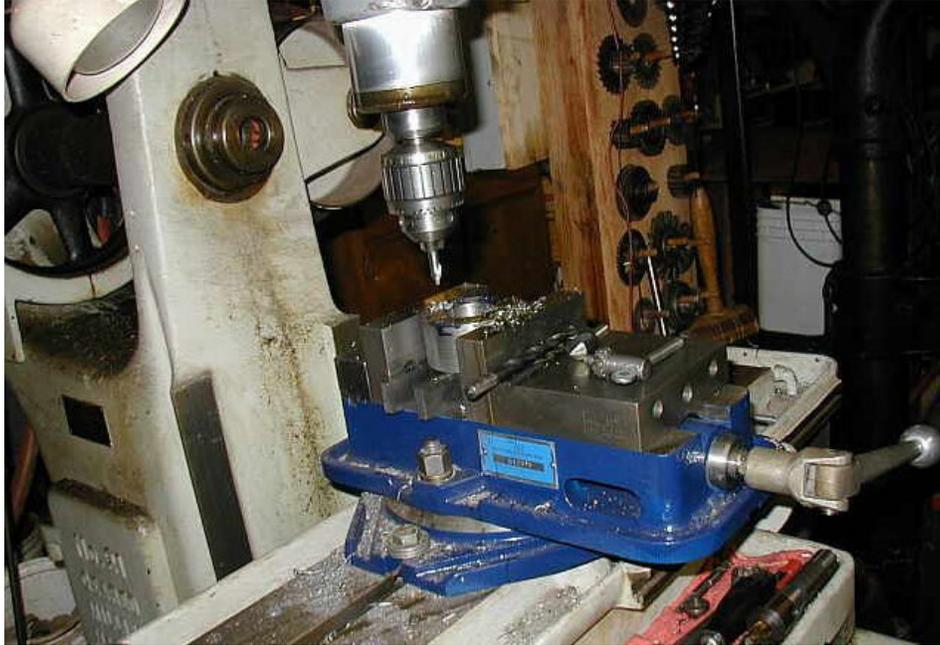
**Figura 81. Morsa montata su trapano.**
